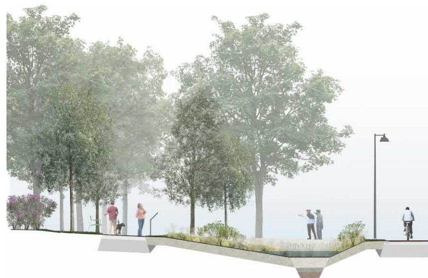
Leikkaus suunnitellusta Hesperianpuiston biosuodatuspainanteesta
